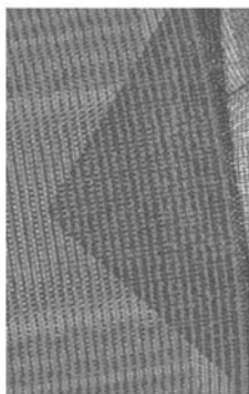
图7 开孔扩压器壁面小孔网格
